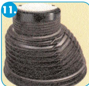
11. **Alternativ:** Dichtelement DN 625 in oberstes Rippen-tal am Konus einlegen. Die Abdeckung B 125 direkt auf den Konus auflegen. Betonauflagering nicht erforderlich.
