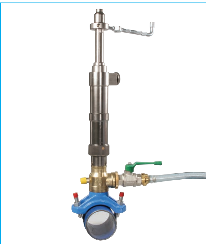
Kugel-Ventil-Anbohrarmatur für AZ-, Guss- und Stahlrohr mit Bohrloch-Dichthülsen-Setzgerät
