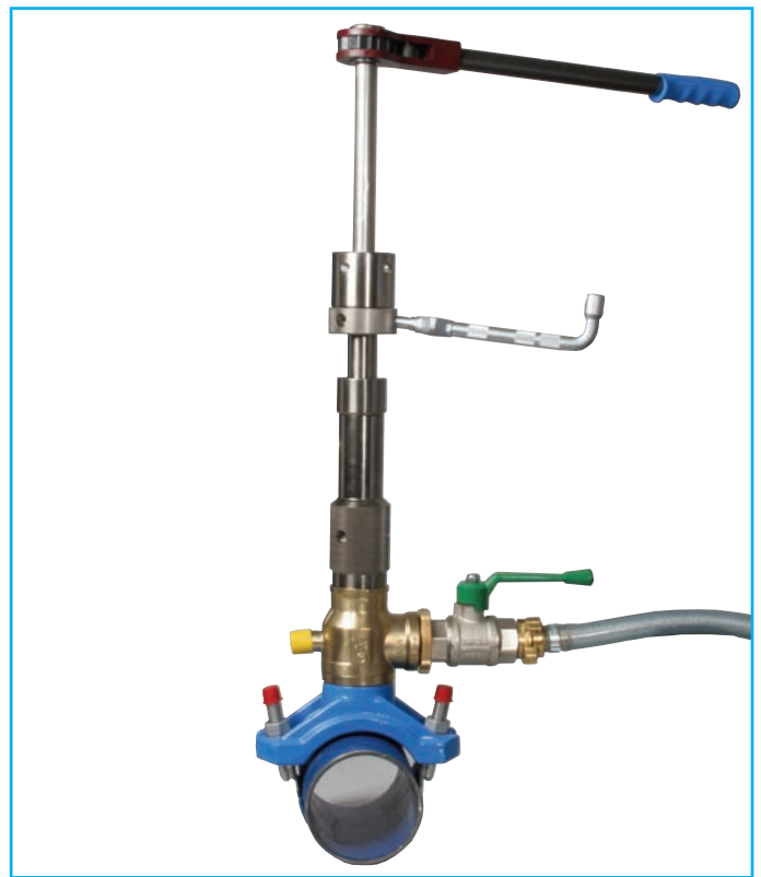
Kugel-Ventil-Anbohrarmatur für AZ-, Guss- und Stahlrohr mit Anbohrgerät
