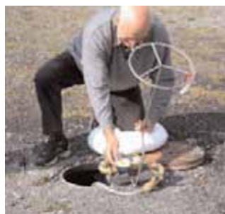
2. Le tuyau flexible permet de déposer et de lire facilement l'installation de compteur à côté de l'ouverture de regard ou de changer de compteur.
