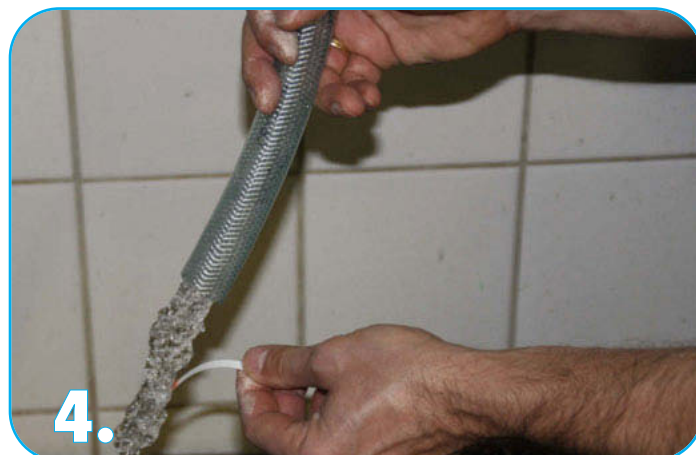
4. Bei Desinfektionsbetrieb kann das Desinfektionsmittel mit entsprechendem Teststreifen nachgewiesen werden. Bei Blaufärbung ist das Desinfektionsmittel im Prüfwasser bestätigt.
